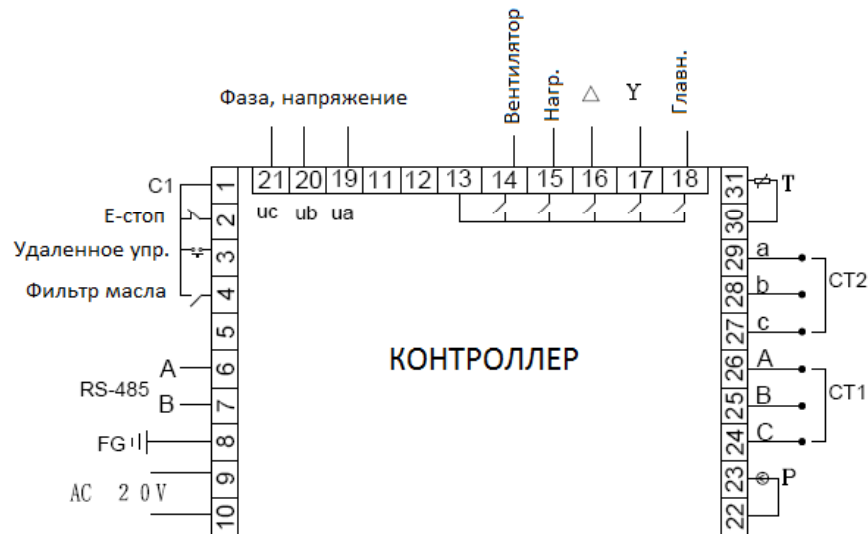
Рисунок 4.2.1 Схема расположения клемм
